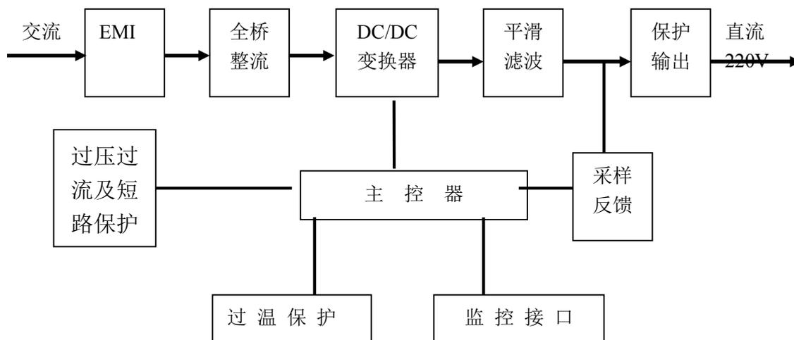
RHD1B02MK (RHD1A04MK) 整流模块的原理框图
